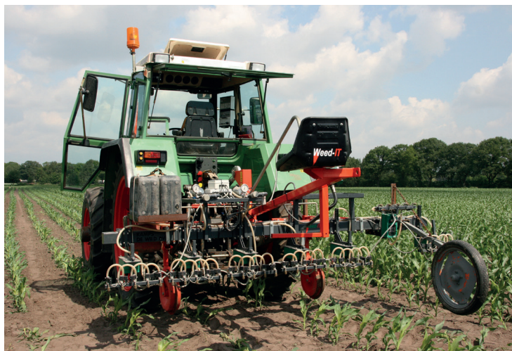
Foto: Een weed-it maakt precisietoepassing van gewasbeschermingsmiddelen mogelijk, afgestemd op de behoefte van het gewas, de bodem en (plaats)specifieke omstandigheden.
