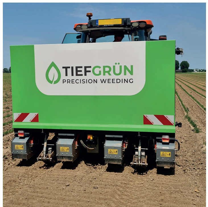
Foto: Niet-chemische onkruidbestrijding in de rij, met realtime-beeldherkenning en heet water.
