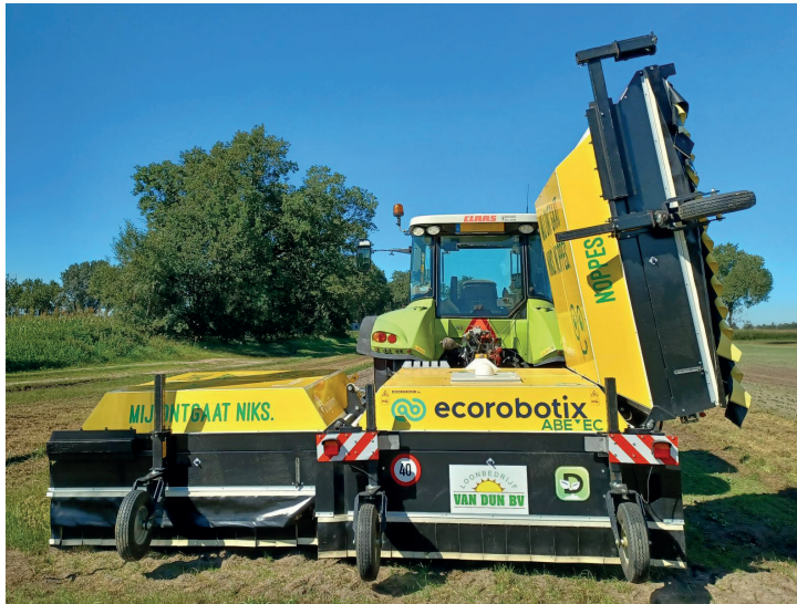
Foto: Spotsprayer met realtimetechniek en apart aangestuurde spuitdoppen.
