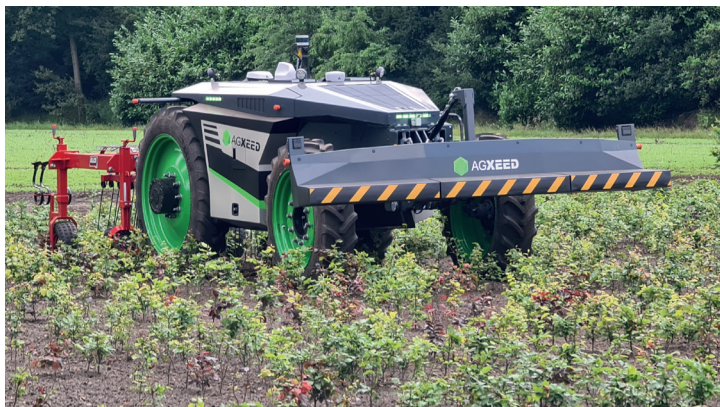
Foto: De AgBOT W4 serie van AGXeed in actie in de boomkwekerij. Deze machine kan onder andere het zaaibed voorbereiden, wieden, schoffelen en pleksgewijs spuiten
