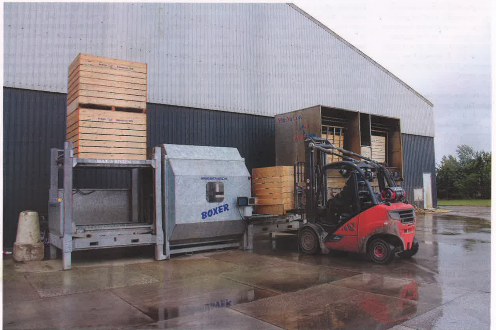
Na de Marnacon-kistenreiniger (rechts) gaan de kuubskisten in de Boxer-kistendraaier om ze te ontsmetten.
