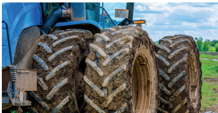
Met dubbellucht wordt het machinegewicht over een groter oppervlak verdeeld, waardoor bodemdruk vermindert.
