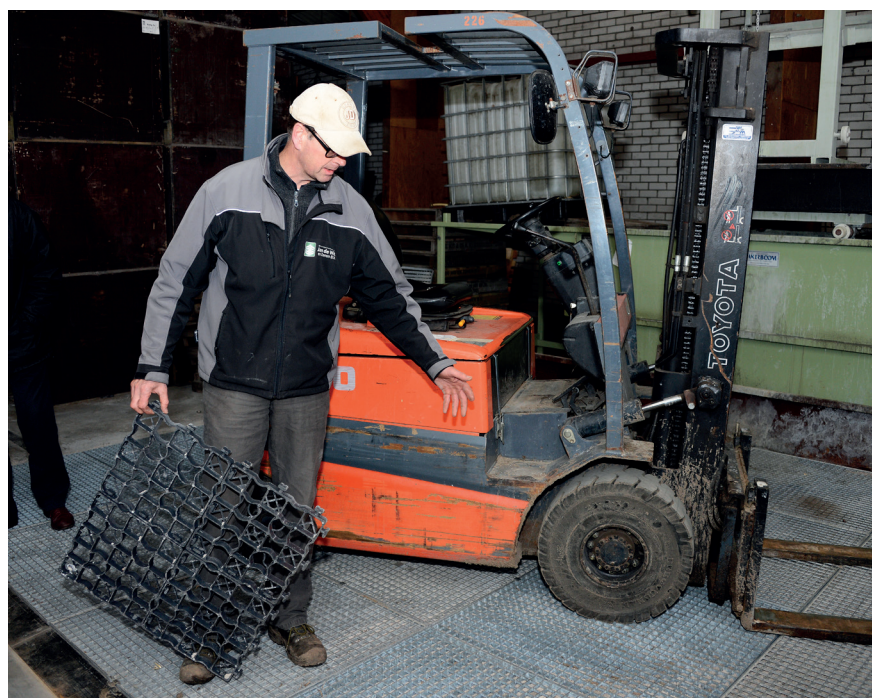
Lekken van dompelvloeistof op de grond voorkomt u met kunststof roosters met absorberend materiaal ertussen.
