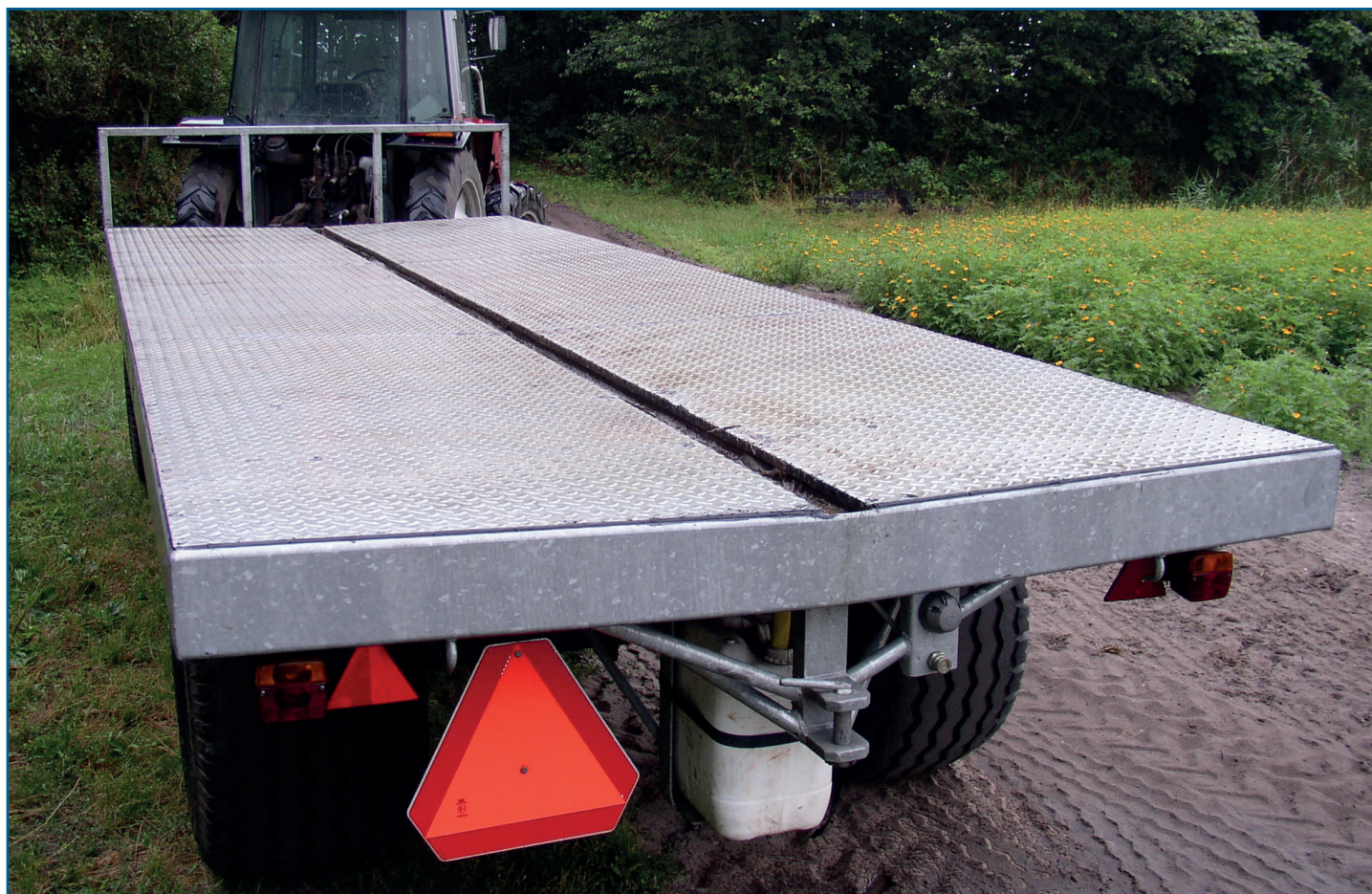
Met een transportwagen met lekgoot en opvangbak voorkomt u dat dompelfloeistof uit fust en bollen tijdens het transport op de grond komt.
