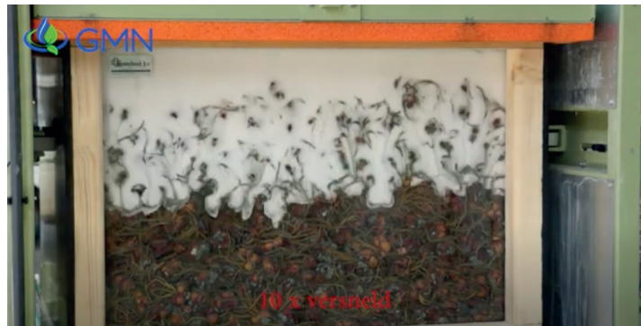
Bij persschuimen wordt het ontsmetmiddel in de vorm van schuim door de kist heen geperst (bron: Groen Kennisnet).
