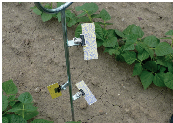
Met watergevoelig papier kunt u de indringing in het gewas, de bedekking en drift inzichtelijk maken voor verschillende spuitinstellingen.
