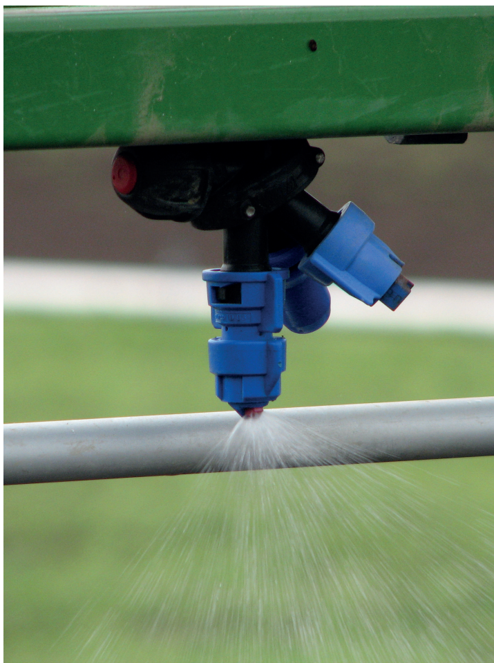
Spuitdruk, dopgrootte, tophoek en doptype zijn van invloed op de druppelgrootte en daarmee de hoeveelheid drift.
