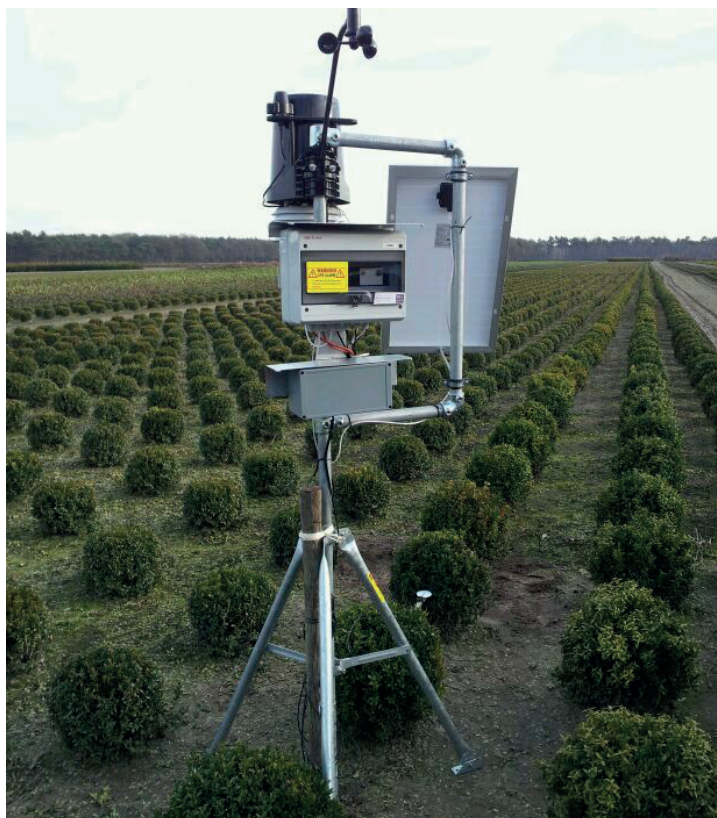
Een weerpaal meet de weersomstandigheden (o.a. temperatuur, luchtvochtigheid en windsnelheid) op het perceel of tussen het gewas. Bron: Delphy
