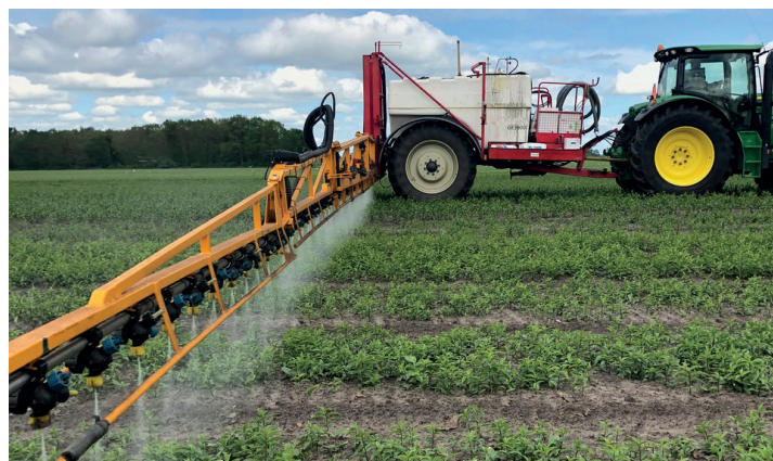
Verlaagde spuitboom in de lelieteelt, Drenthe. Bron: Fernhout BV
