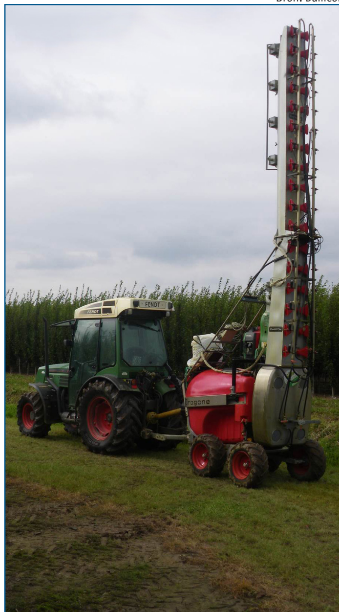
De mastspuit bereikt d.m.v. venturidoppen en sensoren een driftreductie van 96%, en heeft een bereik tot 6 meter hoogte.
